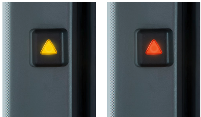
Lenkt den Blick des Fahrers auf die Gefahrenzone: gelb oder rot aufleuchtende Warnlampe in der A-Säule.
